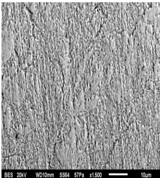
Gambar 16. Struktur mikro bagian dalam tapak roda impor hasil analisa *scanning electron microscope*, menggunakan etsa nital 5%, perbesaran 1500 x
