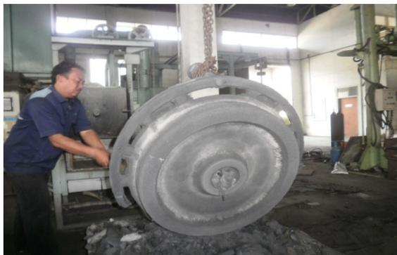
Gambar 3. Pembongkaran prototipe roda kereta api dari cetakan pasir
